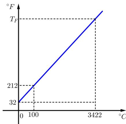
Denotando por  $T_F$  a temperatura de fusão do Tungstênio em graus Fahrenheit, temos que  $\frac{212 - 32}{100} = \frac{T_F - 32}{3422}$ .
